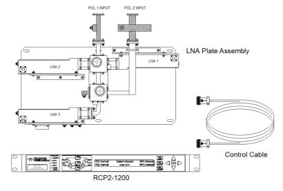
Figure 10: System Components, 1:2 Redundant LNA System
