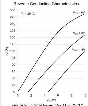
Figure 9: Typical I<sub>SD</sub> vs. V<sub>SD</sub> (T<sub>J</sub>= 25 °C)
