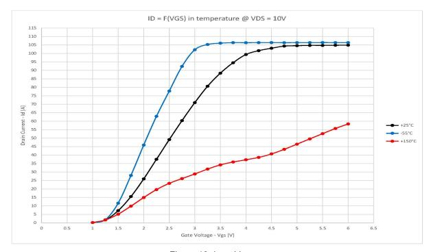
Figure 19: I<sub>D</sub> vs V<sub>GS</sub>
