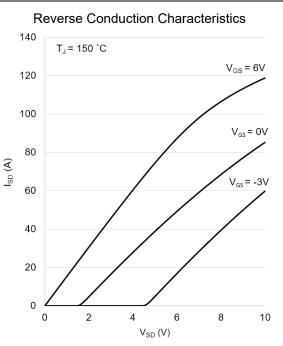
Figure 10: Typical I<sub>SD</sub> vs. V<sub>SD</sub> (T<sub>J</sub>= 150 °C)
